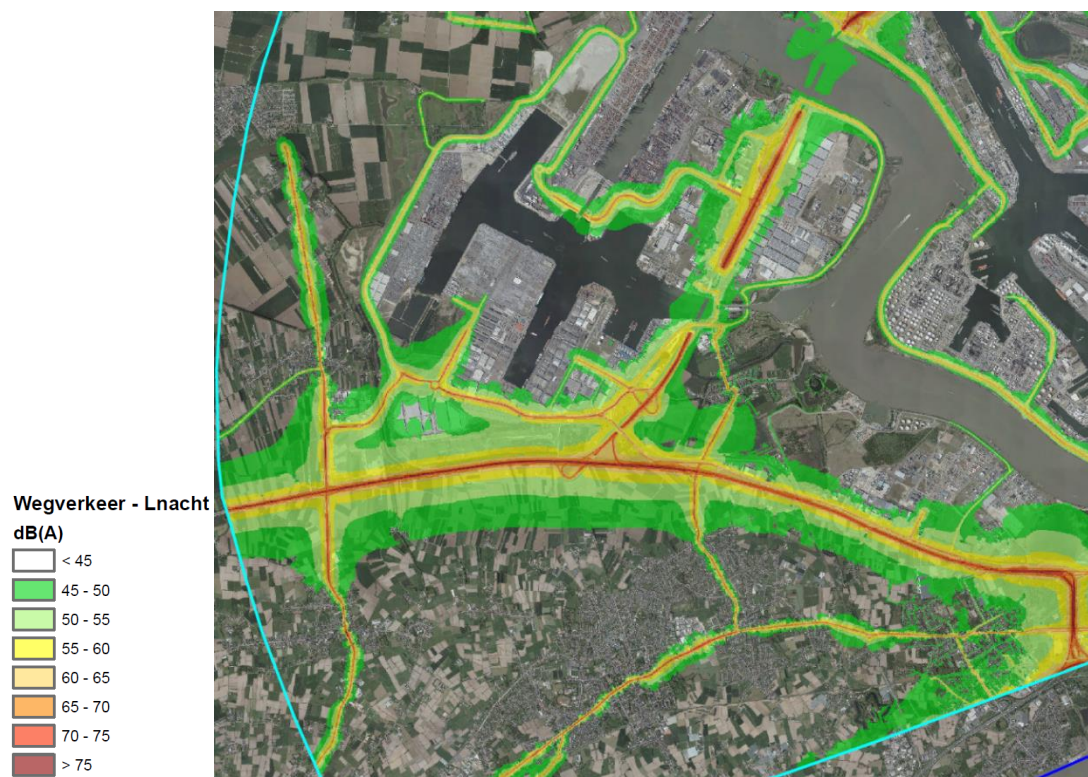
Figuur 3-46: Gewogen gemiddelde geluidsbelasting (Lnacht) voor het havengebied - wegverkeer, spoorverkeer en industrie (bron: Havenbedrijf Antwerpen: 'Geluidskaarten tweede versie' - havengebied Antwerpen', overgenomen uit het MER ECA.
