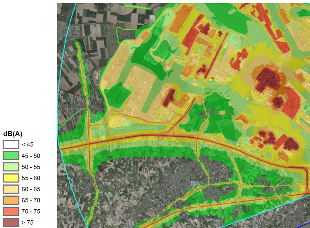
Figuur 3-48: Gewogen nachtgemiddelde geluidsbelasting ( L_{nacht} ) voor het havengebied - wegverkeer (bron: Havenbedrijf Antwerpen: 'Geluidskaarten tweede versie' - havengebied Antwerpen', overgenomen uit het MER ECA.
