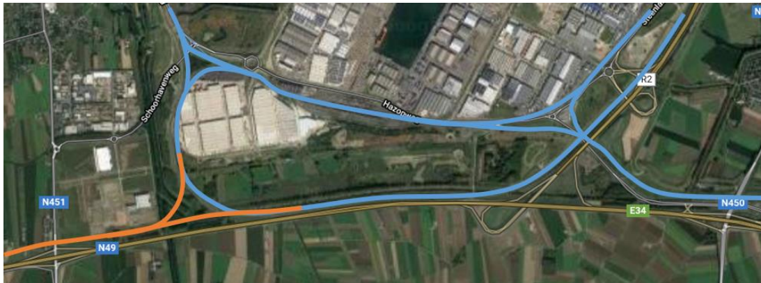
Figuur 3-29: Verlenging goederenspoorlijn Gent-Antwerpen langs E34 (oranje=te realiseren verlenging; blauw=gerealiseerd) (obv visienota Ontwerp-Routeplan 2030)
