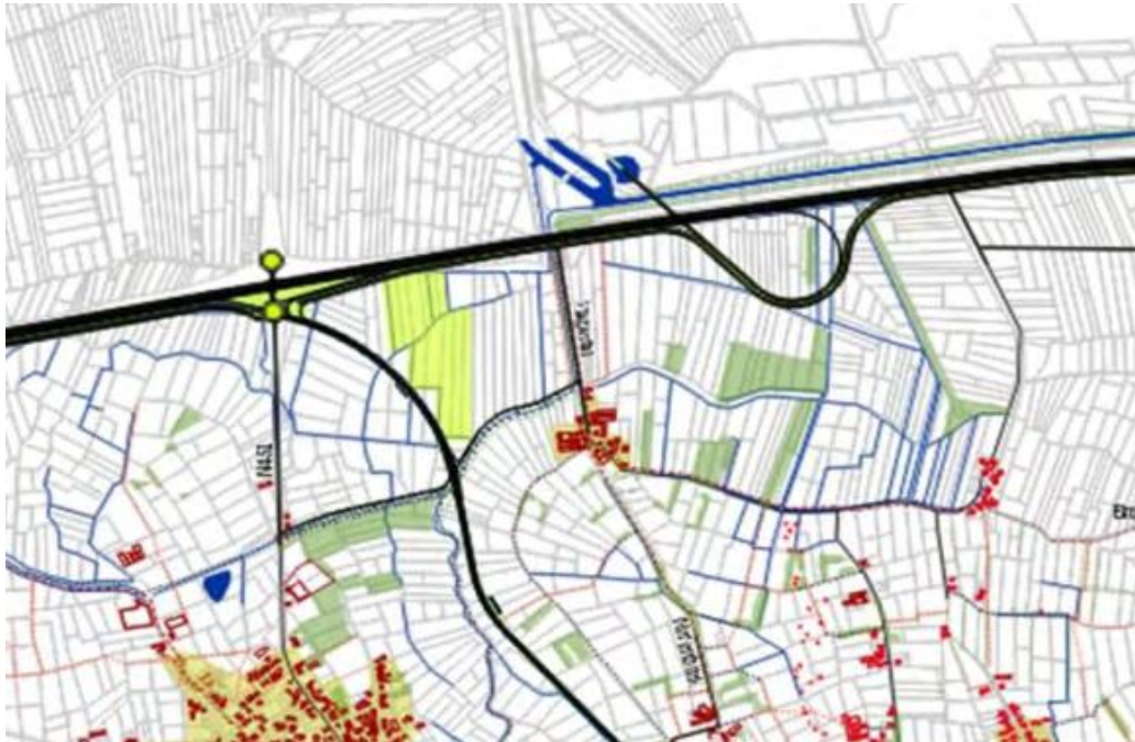
Figuur 3-10 Uitsnede scenario 3 variant 1 Nieuwe ontsluitingsweg parallel met N451 aansluitend aan complex Vrasene en parallelweg tussen N451 en N50. (Deelnota ontwerp onderzoek tracés scenario's, Vectris)
