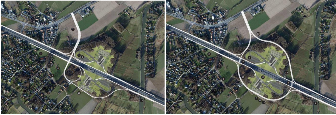
Figuur 3-4: De twee bestudeerde O-varianten: links O1+ (trompet), rechts O3 (lus)
