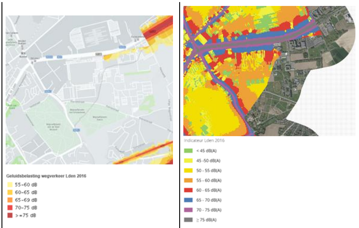
Figuur 4.21: Geluidsbelasting wegverkeer (Lden) op Vlaams en Brussels grondgebied ter hoogte van het plangebied (bron: Geopunt Vlaanderen & Leefmilieu Brussel – referentiejaar 2016)
