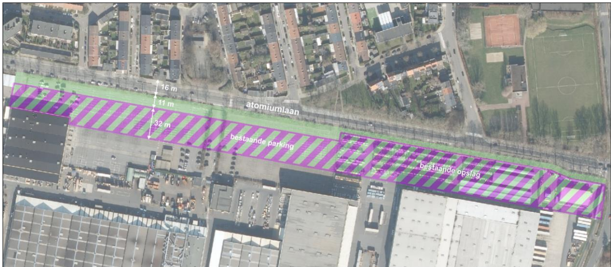
Figuur 4-1 Detail bufferstrook Atomiumlaan
