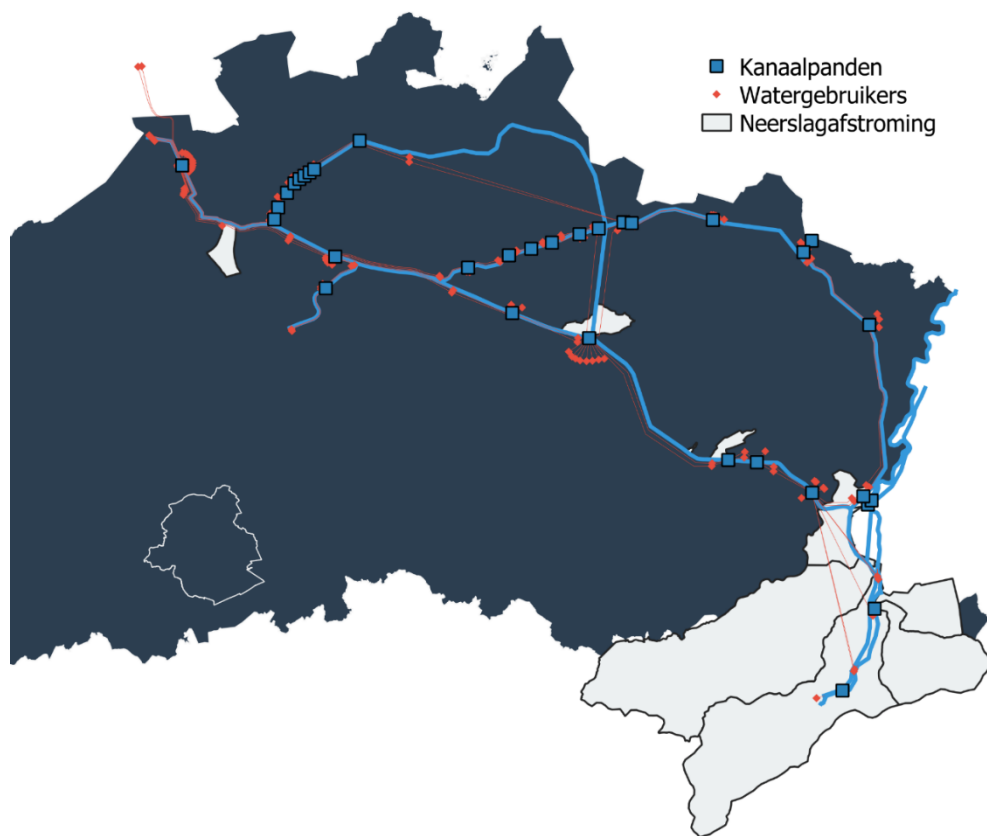
Figuur 225: Het beschouwde oppervlaktewatersysteem van Albertkanaal en Kempische kanalen, met aanduiding van de beschouwde kanaalpanden, de locaties van de beschouwde watergebruikers en de beschouwde neerslagafstromingsgebieden buiten Vlaanderen en de op- en afwaartse randen voor de Maas.
