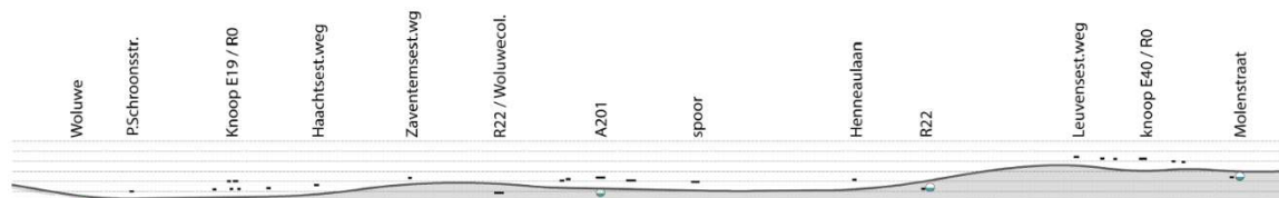
Figuur 76: bestaand lengteprofiel zone Zaventem
