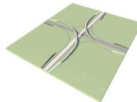
Figuur 11: Plankaart voorbeeld symmetrische verkeerswisselaar R0/E40 Sint-Stevens-Woluwe (zonder parallelstructuur)
