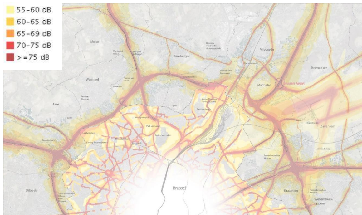
Figuur 99: knelpunt geluidsoverlast: geluidsbelasting wegverkeer en luchtverkeer Lden 2016 (Bron: Geopunt - BIM)
