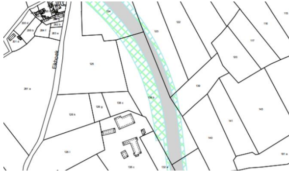
Figuur 103: Voorbeeld van een deel van een bestemmingsplan waarbij een gebied voor wegeninfrastructuur in functie van nieuwe infrastructuur (grijze zone) wordt bestemd. Aanpalend wordt in overdruk een zone voor landschappelijke en functionele inpassing van wegeninfrastructuur voorzien (zie uitleg bij 3.2.2. Voorbeelden van bestemmingen in overdruk).
