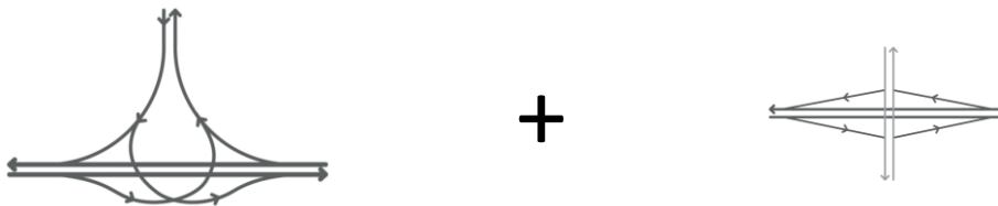
Figuur 144: Combinatie driearmige verkeerswisselaar + Hollands complex
