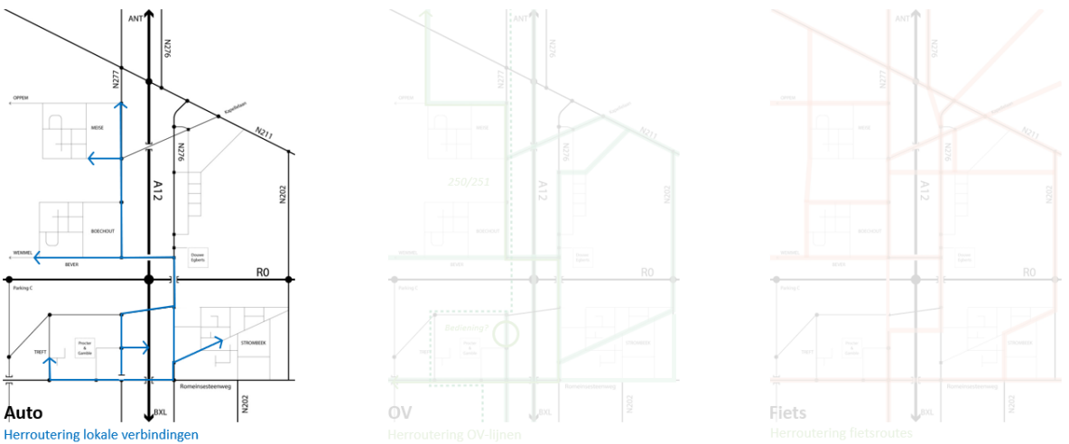
Figuur 84: Schematische weergave ontsluiting omgeving A12 - alternatieven G1a, G1b, G2a' en G2b (ov en fiets ongewijzigd)
