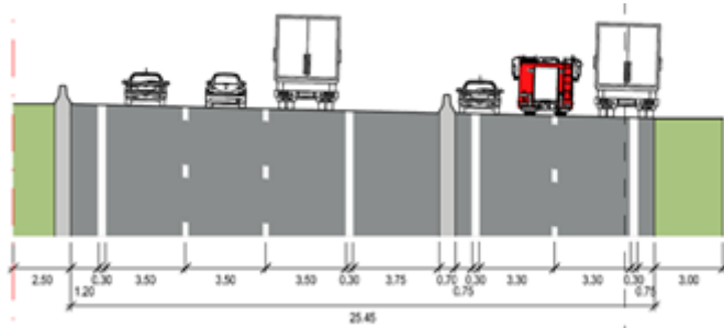
Figuur 17: Principe profiel G2 Loop2: weergave redresseerstroken langs weerszijden van SRW i.f.v. reddingstrook voor hulpdiensten.
