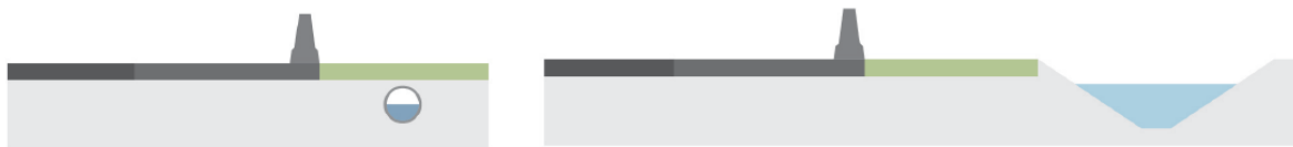
Figuur 91: Schematische weergave waterkoker (figuur links) en afwateringsgracht (figuur rechts)
