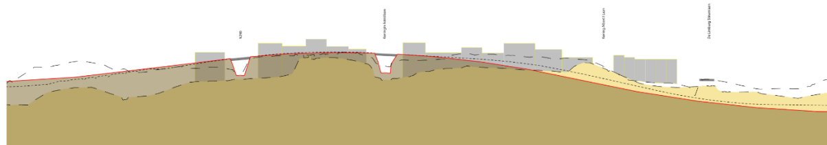
Figuur 34: Geoptimaliseerd lengteprofiel a met onderdoorgangen zone Wemmel-Jette – Loop 1 = Loop 2 (LPa_WM) – het lengteprofiel 5x verschaald is t.o.v. de hoogte (Y-as)
