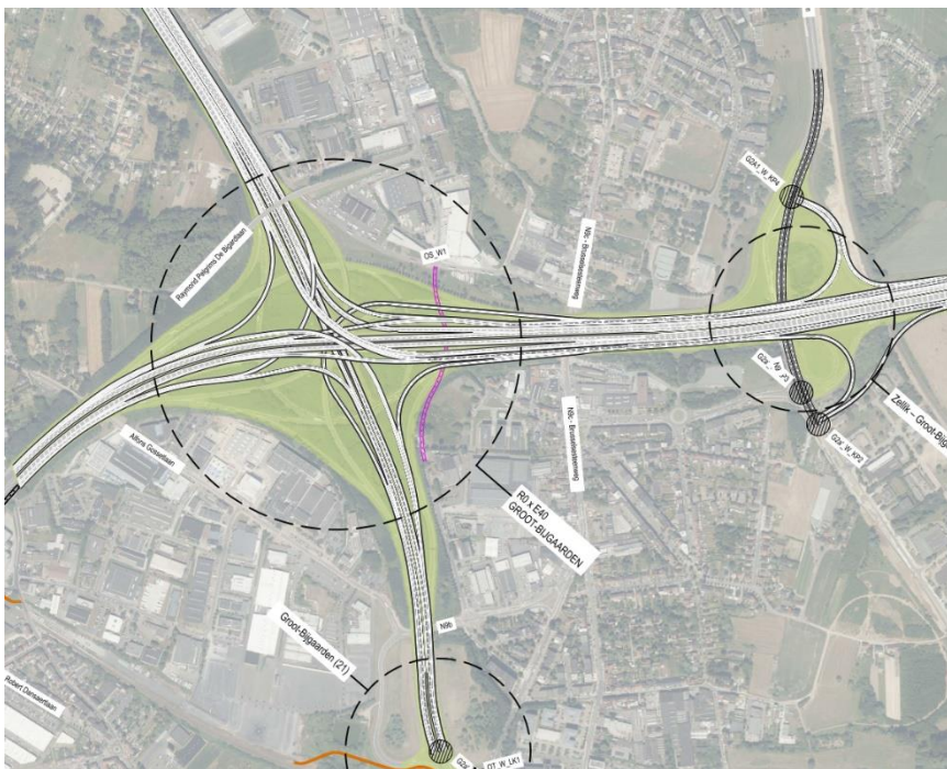
Figuur 61: Verkeerswisselaar/ knoop E40 Groot-Bijgaarden variant a' in G2 – Loop 2 → variant 4/4 knoop SRW
