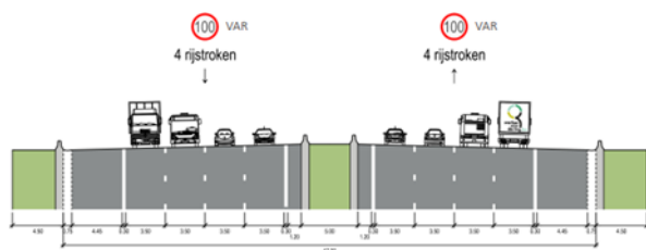
Figuur 9: Typedwarsprofiel G1A2
