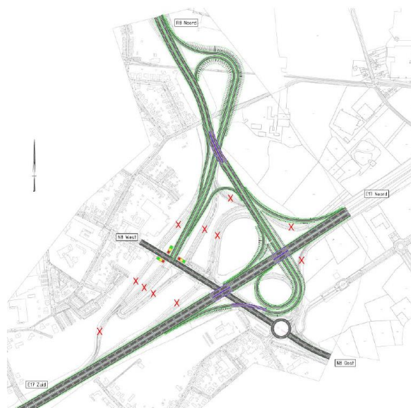
Figuur 2-51: Variant 1 voor de optimalisatie van het complex Kortrijk-Oost in geval van niet-sluiten R8
