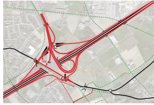
Figuur 2-76: Kortrijk-Oost met ingesleufde E17 en parallelwegen
