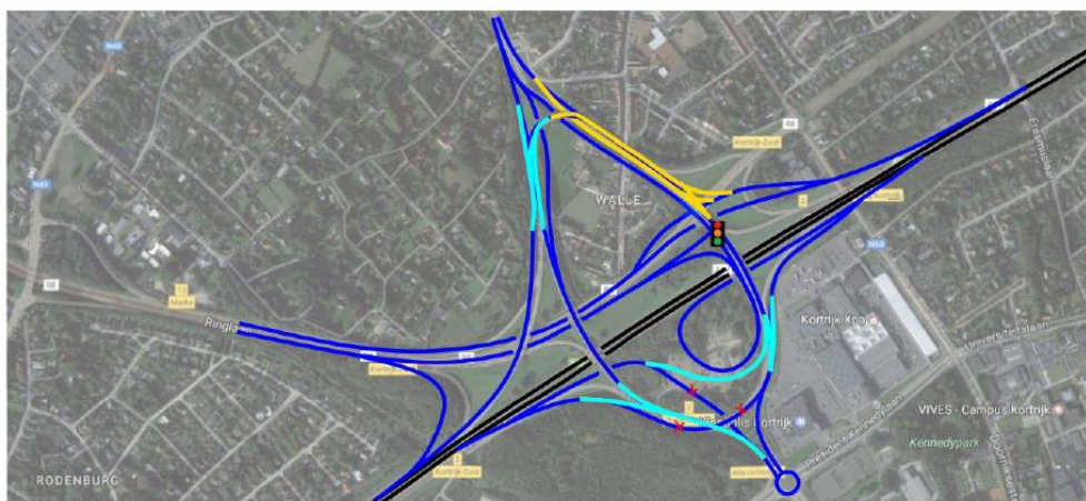
Figuur 2-48: Variant 6B-2 voor de optimalisatie van het complex Kortrijk-Zuid in geval van niet-sluiten R8
