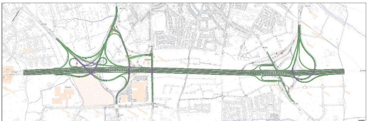
Figuur 2-68: Variante 2a voor de optimalisatie van de complexen Kortrijk-Oost en-Zuid met sluiting R8: sluiting R8 naast de E17 met één rijrichting noordelijk en één rijrichting zuidelijk van de E17
