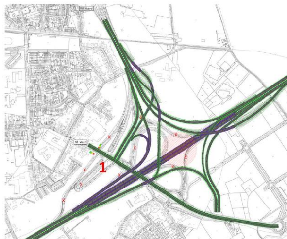
Figuur 2-65: Niet-weerhouden variant 5 voor de optimalisatie van het complex Kortrijk-Oost met gedeeltelijke overkapping van de E17 in geval van niet-sluiten R8
