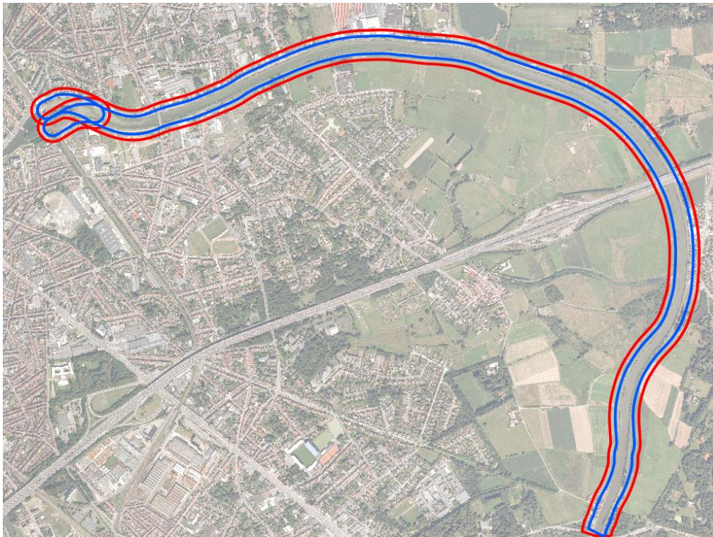
Figuur 7-42 Invloedszone grondwaterstandsstijging van 5 cm in het planalternatief bij een doorlatendheid van 0,1 m/d (blauwe lijn : as waterloop + 45 m) of 1 m/d (rode lijn : as waterloop + 75 m)
