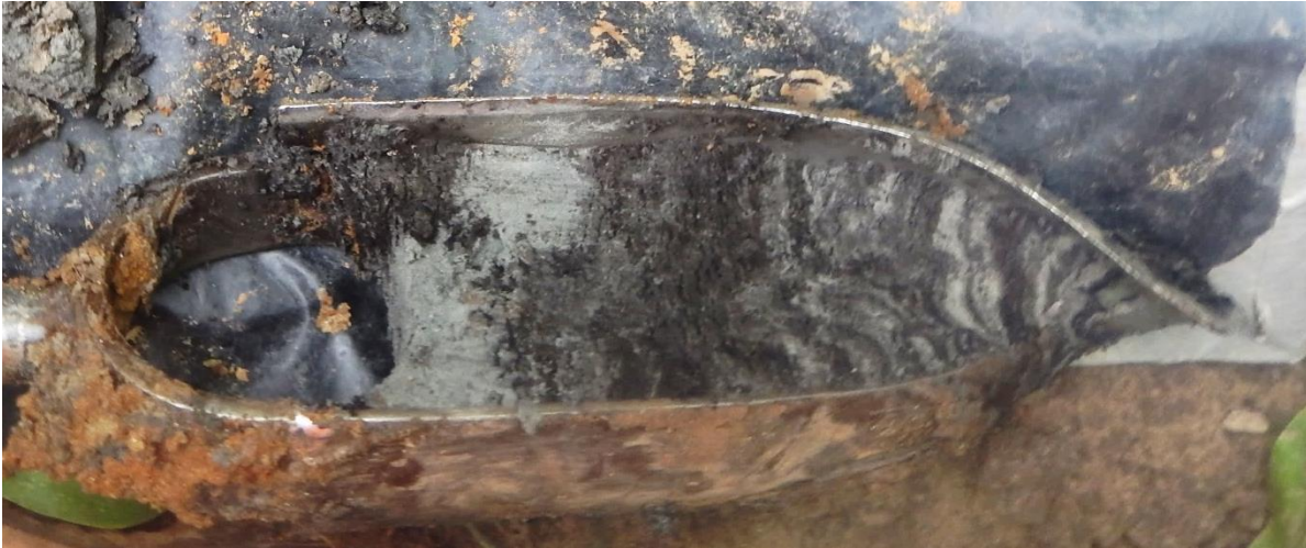
Figuur 41: foto van sediment uit boring 3 in de boorkop (ca. 135-150cm diepte). Hierin is de gelaagdheid zeer duidelijk zichtbaar.
