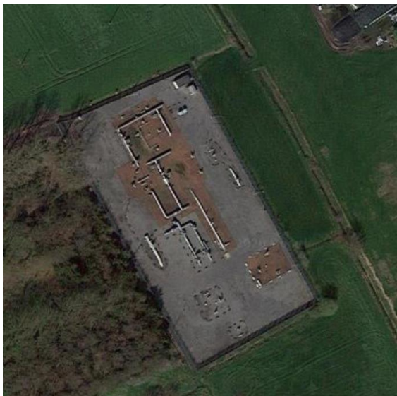
Figuur 8-5 bovenaanzicht schraapkolffstation
