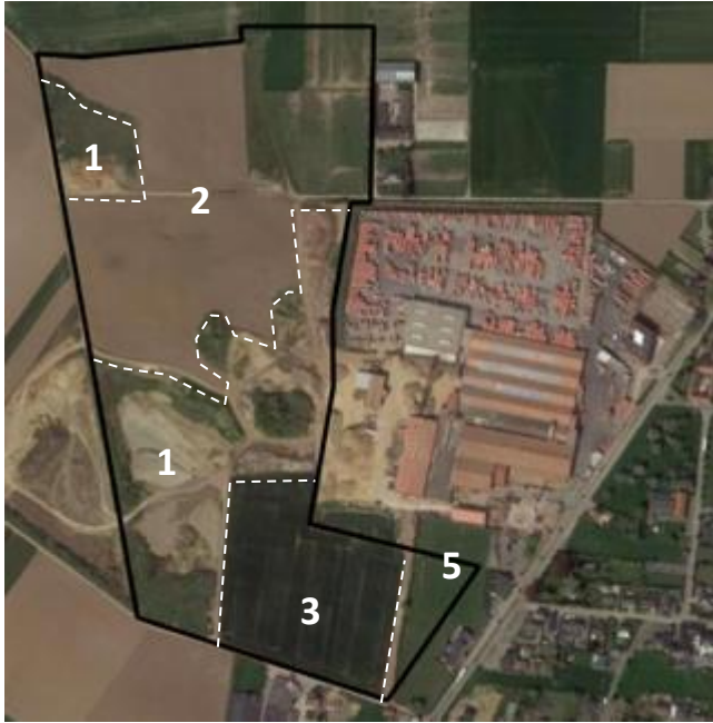
Figuur 4-8: Uitbreidingszone van de bedrijfssite conform planologisch attest. De witte stippellijn is de grens is tussen het meest recent ontgonnen ontginningsgebied (1) en de gronden opnieuw in landbouwgebruik na ontginning (2 en 3).
