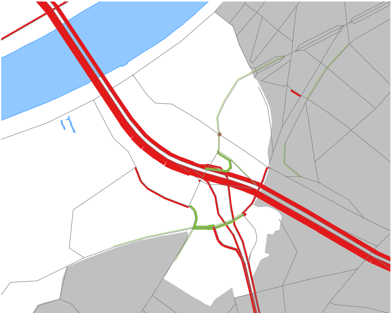
Figuur 26: Aangepast concept knoop-Zuid zonder vrachtverbod Kennedytunnel: verschillenplot ten opzichte van het scenario met vrachtverbod (verschil in pae/u) tijdens de avondspits
