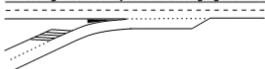
afbeelding 4.13. Principeschets invoeging met tweestrooks toeleidende rijbaan
