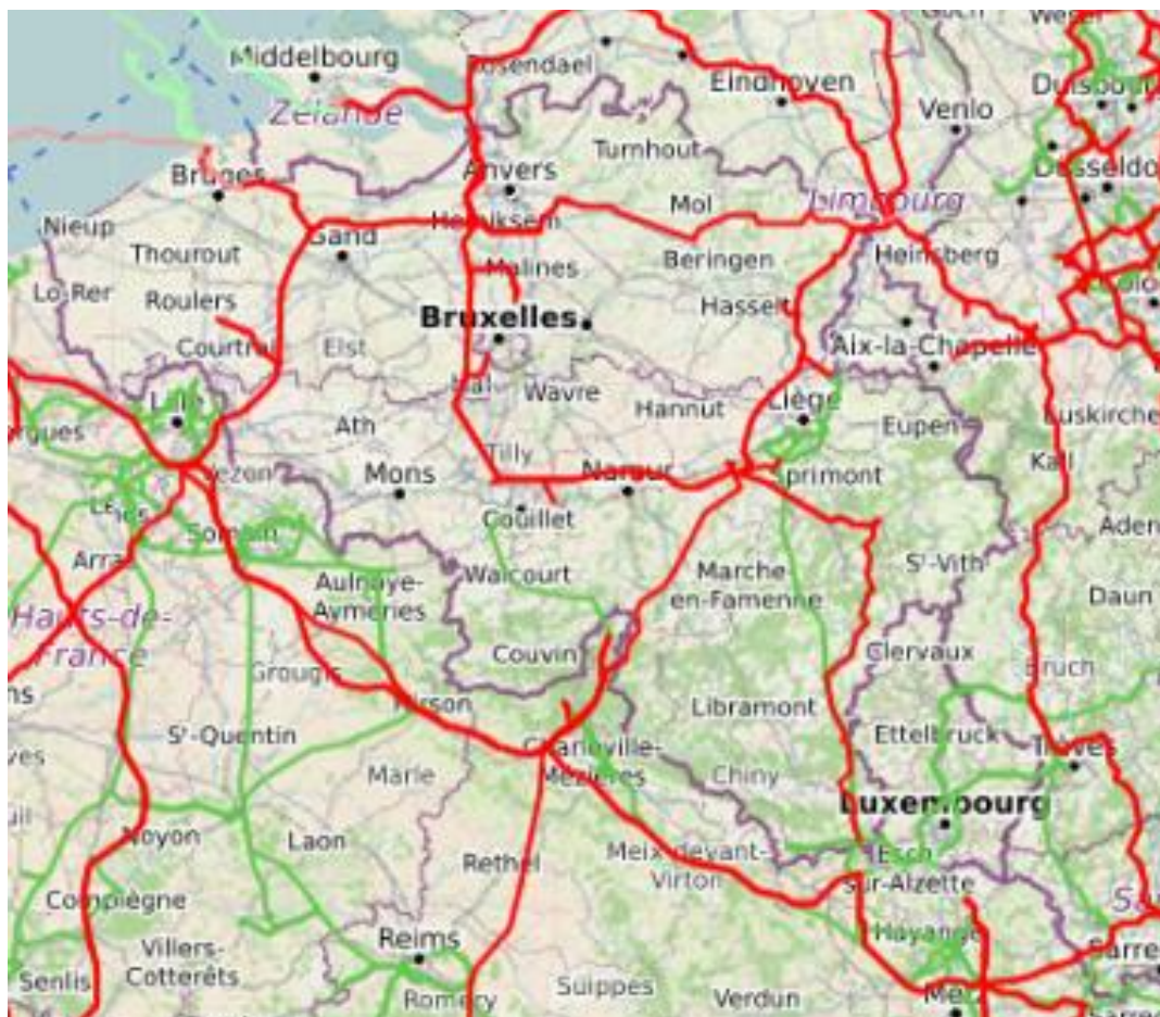
Figuur 3-2 Het Centrale Transmissienetwerk 380 kV in België en omgeving (opgelet copyright https://webkaart.hoogspanningsnet.com/ )
