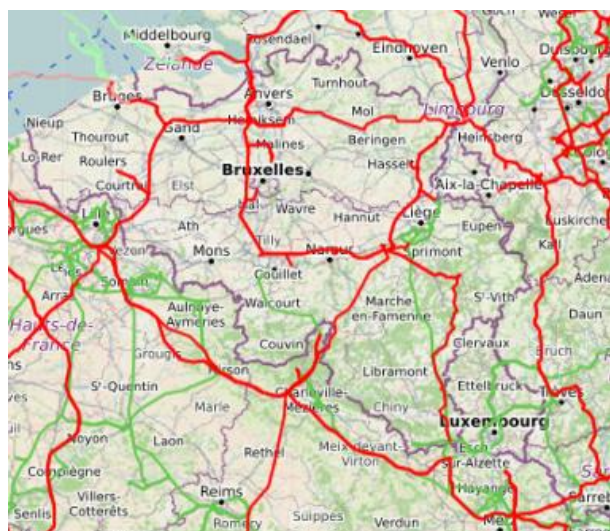
Fig. 8. Het Centrale Transmissienetwerk 380 kV in België en omgeving (opgelet copyright https://webkaart.hoogspanningsnet.com/ )
