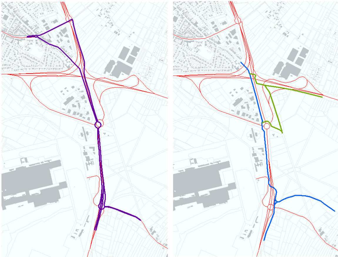
Figuur 21 Busroutes (links) en fietsinfrastructuur (rechts, blauw = fietssnelweg, groen = huidige fietsroutes) in de geplande situatie
