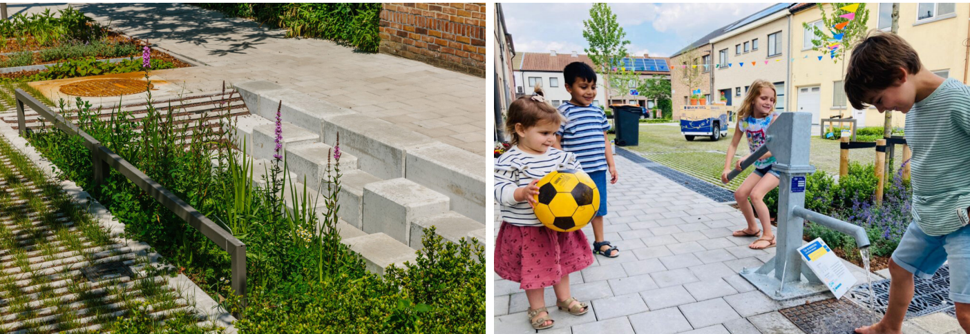
figuur 52 Lokaal opvangen van regenwater en het hergebruik via een waterpomp. (bron: Aziëlaan openingsfeest, stad Antwerpen, Water-link en Aquafin).
