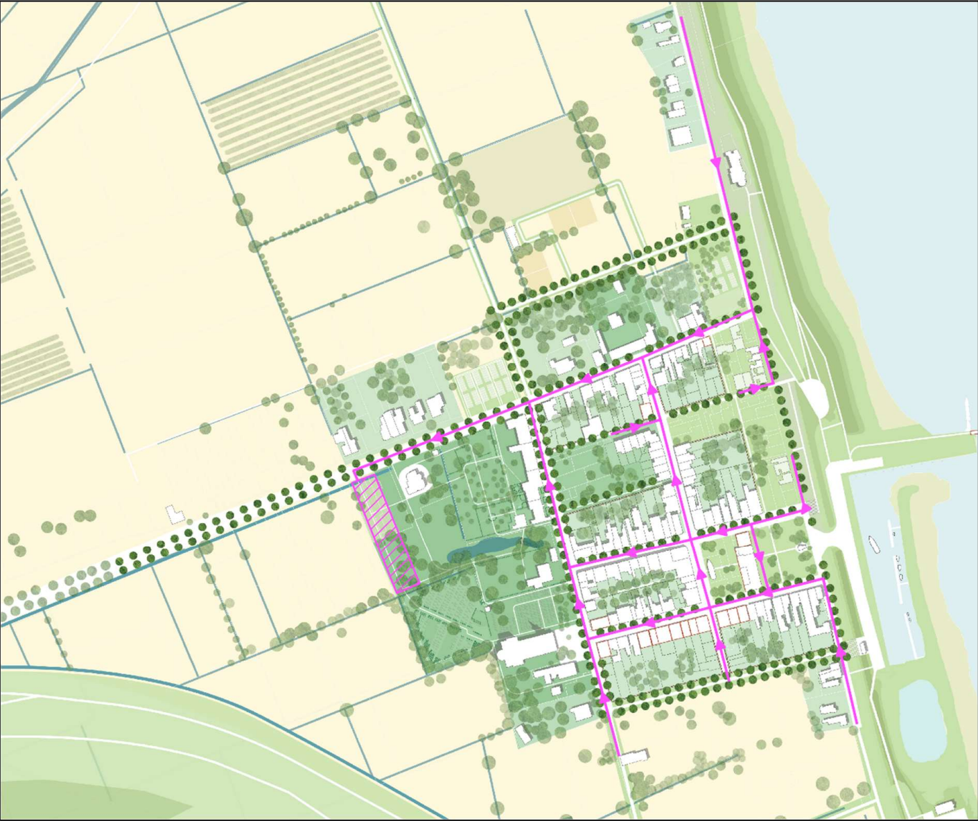
figuur 19 Voorstelling van een collectief afvalwatersysteem met openbare riolering en KWZI
