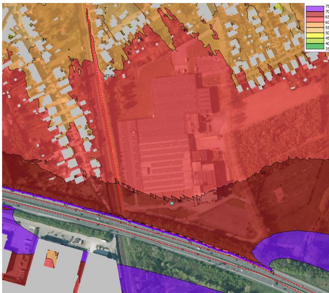
Figuur 4-34: Geluidscontourenkaart Gates bij plaatsing scherm van 3m hoogte
