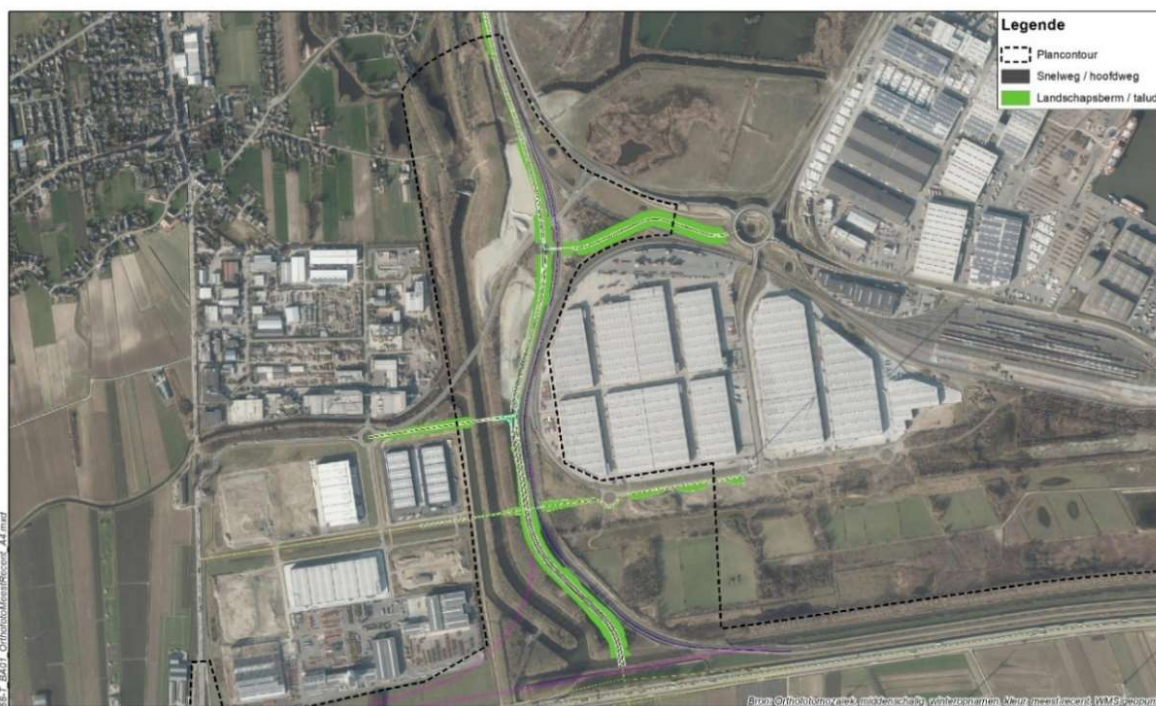
Figuur 17: Het voorkeursalternatief: complex Watermolen als twee T-kruispunten – Het oostelijk niet gebruikte deel van de Schoorhavenweg wordt opgebroken.
