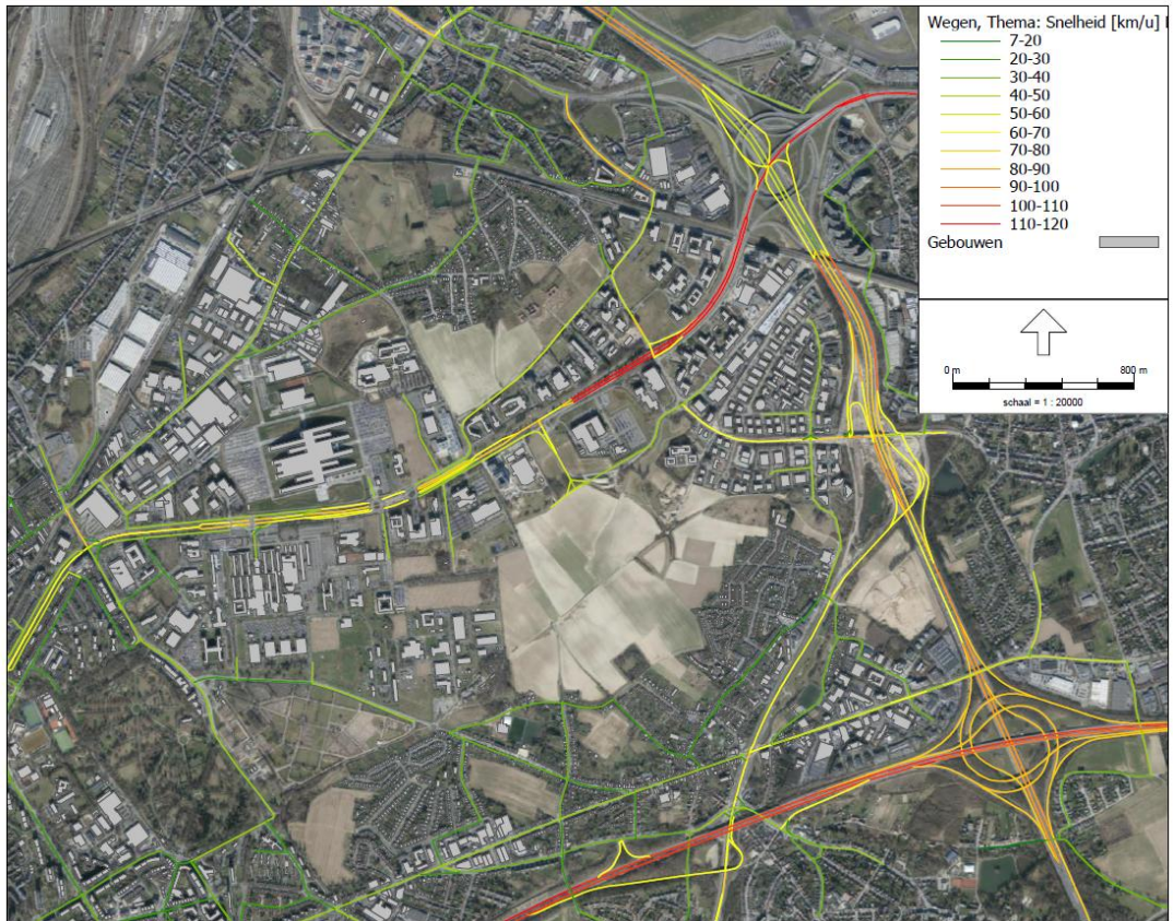
FIGUUR 5-110 OPBOUW 3D-GELUIDSMODEL : SNELHEIDSPROFIEL LICHTE VOERTUIGEN
