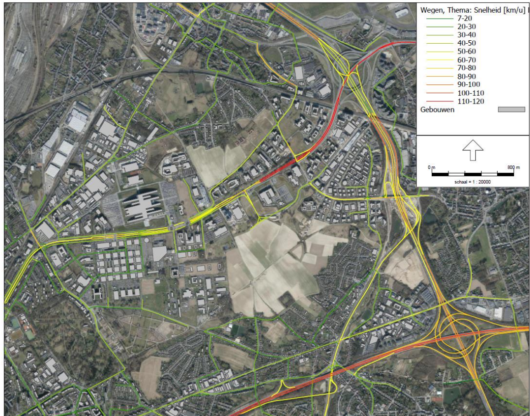
FIGUUR 5-116 OPBOUW 3D-GELUIDSMODEL : SNELHEIDSPROFIEL LICHTE VOERTUIGEN
