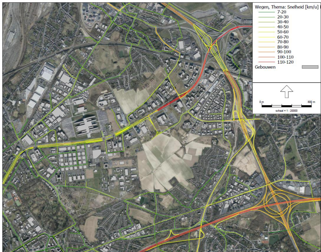
FIGUUR 5-134 OPBOUW 3D-GELUIDSMODEL : SNELHEIDSPROFIEL LICHTE VOERTUIGEN
