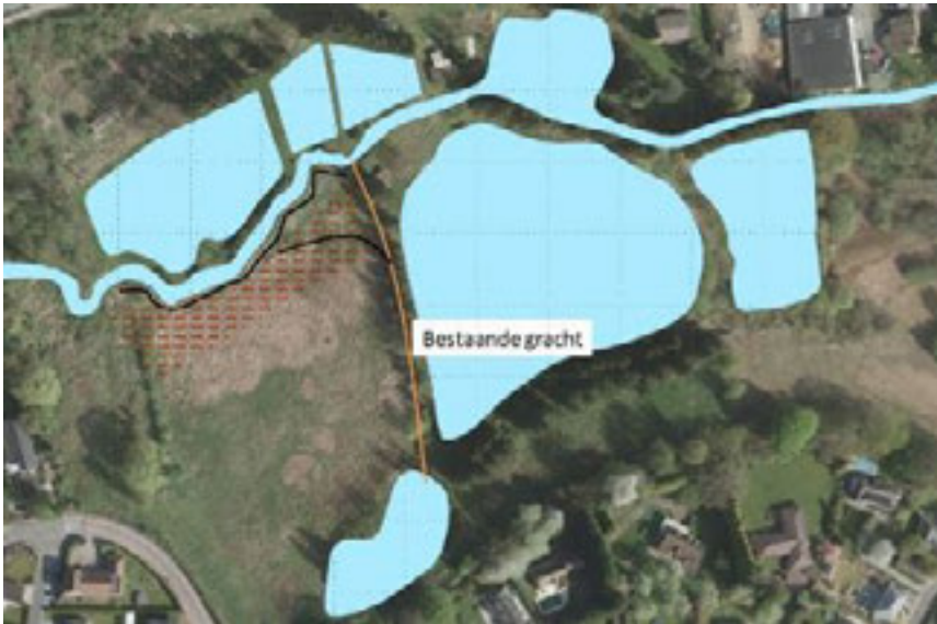
Afbeelding: Omleggen afleiding bronvijver naar moeraszone. Oud traject (oranje) vs nieuw traject en dijk langs IJse (zwart)
