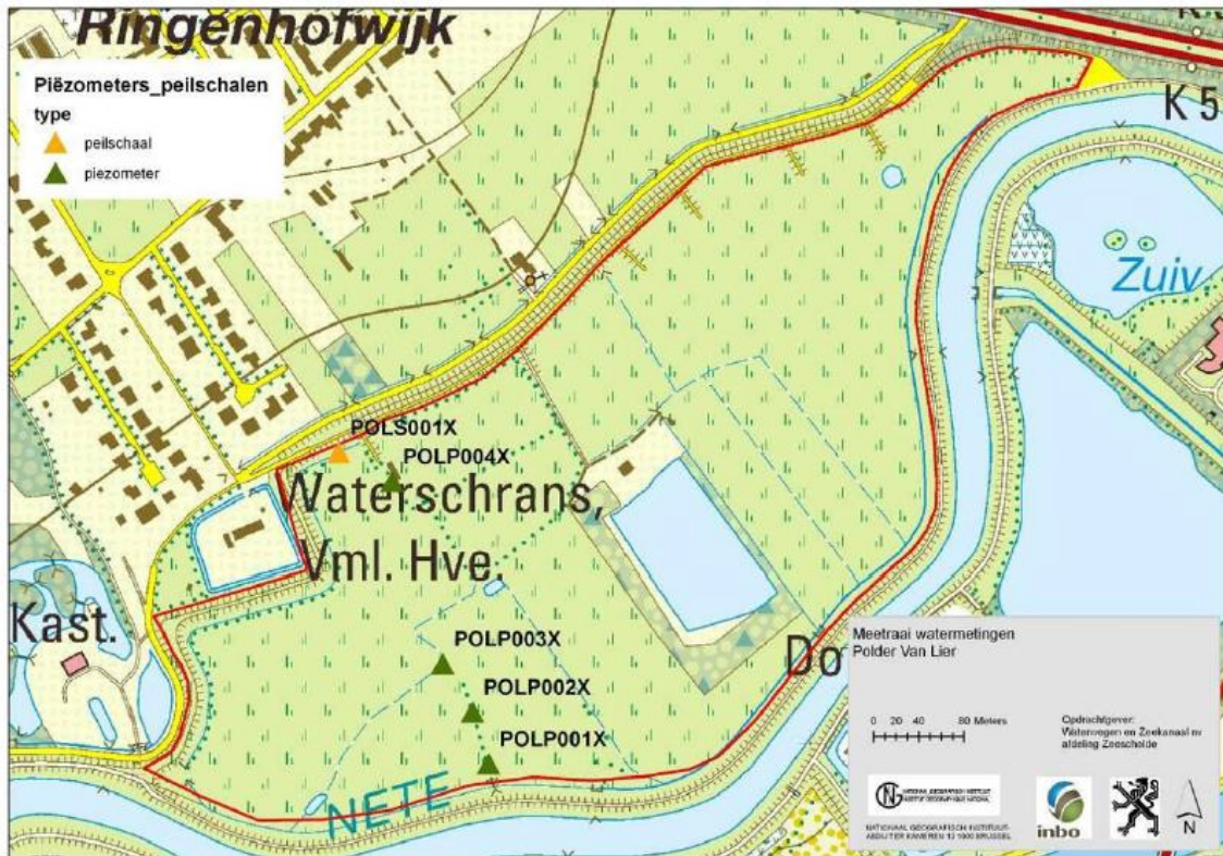
Figuur 8-13: Peilschaal en piëzometernetwerk in de Polder van Lier
