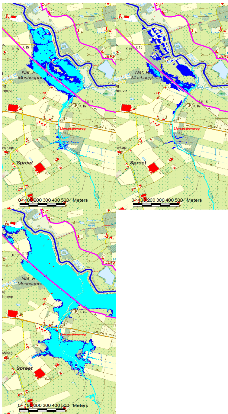
Figuur 208: Overstromingscontouren dec 93 (links), aug 96 (midden), sept 98 (rechts) in huidige toestand (lichtblauw) en opstuwing tot 5.0 mTAW (donkerblauw).
