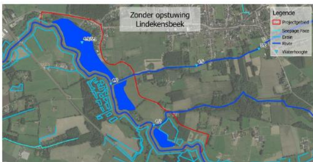
Figuur 251: Schema interne randvoorwaarden in de ontworpen toestand zonder opstuwung van de Lindekensbeek
