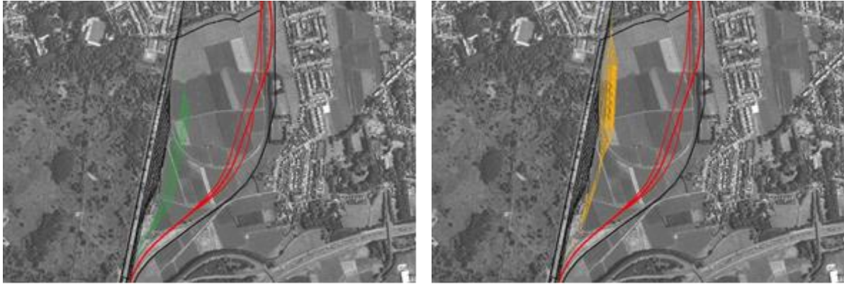
Figuur 3.1: Situering van vertakkingscomplex (rood) en van nieuwe spoorbundel volgens alternatief 1 (rechts, oranje) en volgens alternatief 2 (links, groen) voor aanleg van de nieuwe spoorbundel Luchtbal
