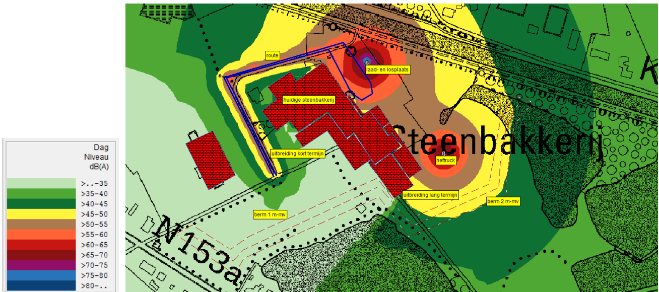
Figuur 6-2: Geluidskaat met heftruck op ca. 50 m van 2 m hoge berm
