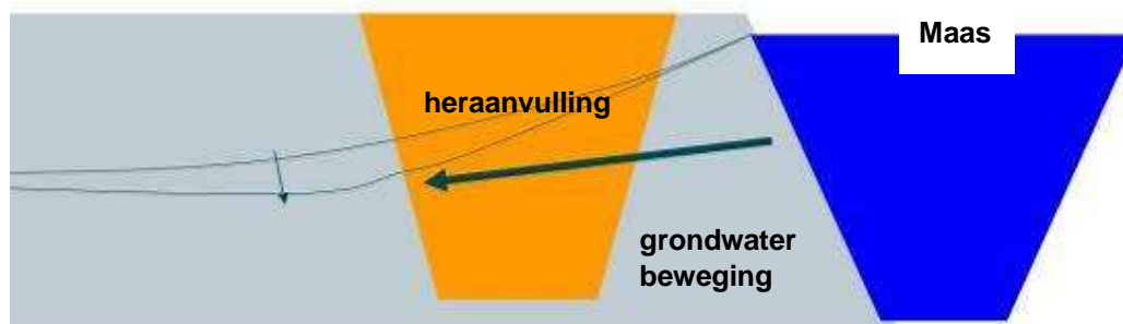
Illustratie 25.2: Schematische voorstelling effect heraanvulling op de opbolling grondwatertafel, bij hoogwater
