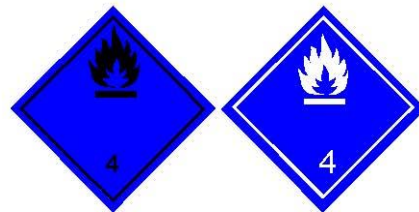
(Nr.4.3) Symbool (vlam): zwart of wit; Achtergrond: blauw Cijfer "4" in de benedenhoek
