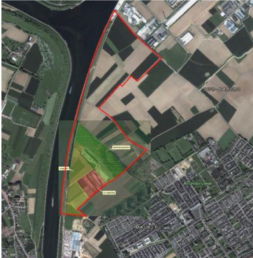
Figuur 10: Luchtfoto met aanduiding ontginning. Sinds medio 2015 is alle leem ontgonnen in GP 93. Herstructureringswerken zijn lopende ter hoogte van de toekomstige Zouwdalcorridor in uitvoering van de vergunning.
