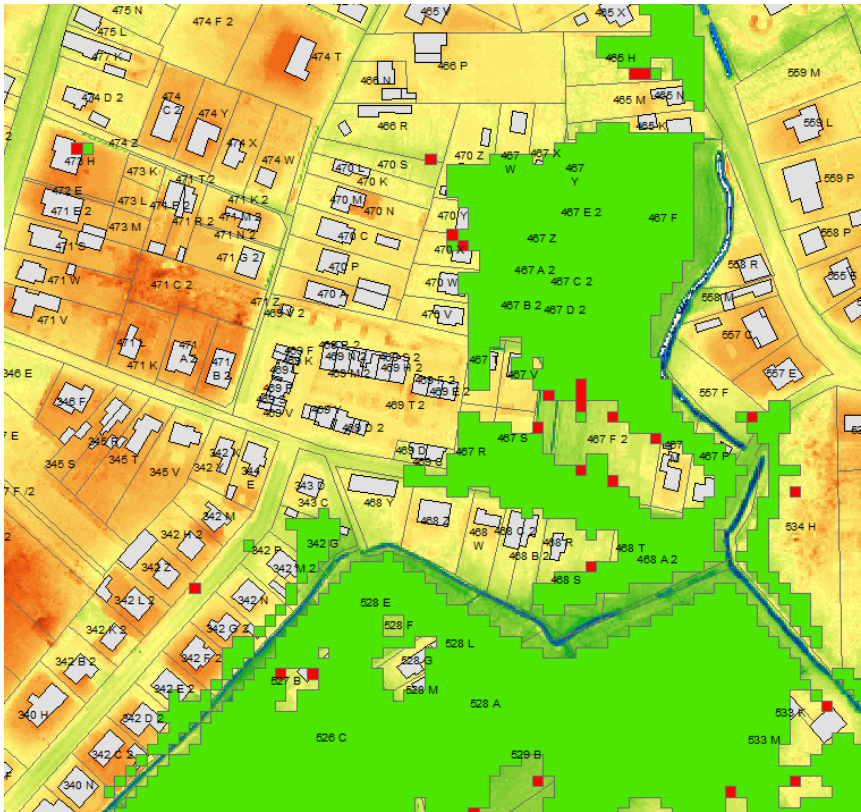
Figuur: modellering bestaande toestand (rood) en toestand na verbreden/verwijderen duikers (groen) bij T100 (groene laag ligt op rode laag maw alles wat groen ziet, moet ook als rood beschouwd worden).
