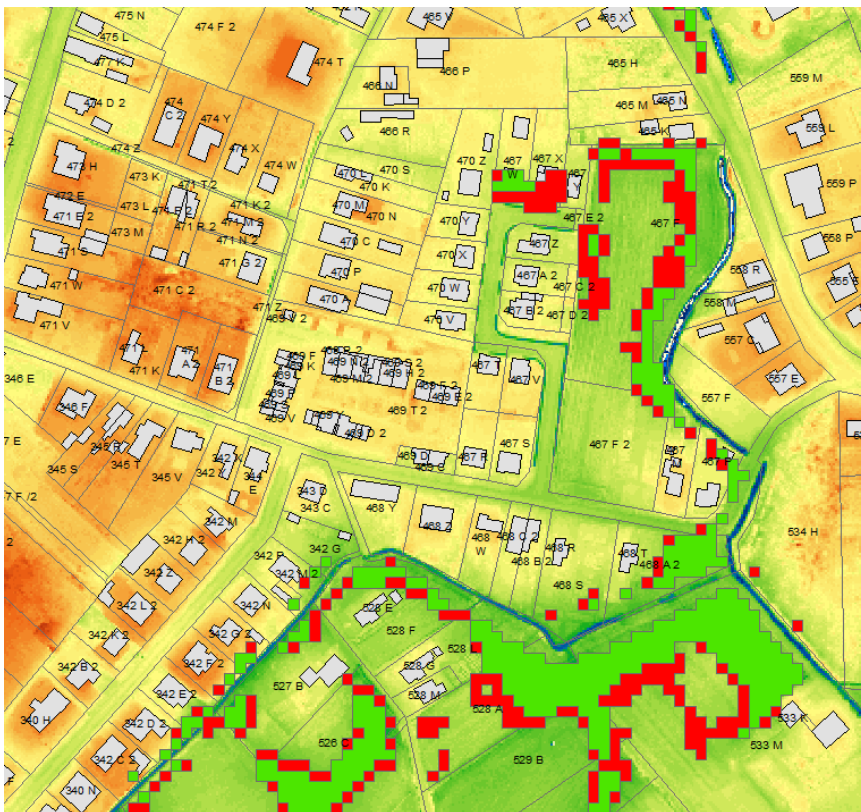
Figuur: modellering bestaande toestand (rood) en toestand na verbreden/verwijderen duikers (groen) bij T25 (groene laag ligt op rode laag maw alles wat groen ziet, moet ook als rood beschouwd worden).
