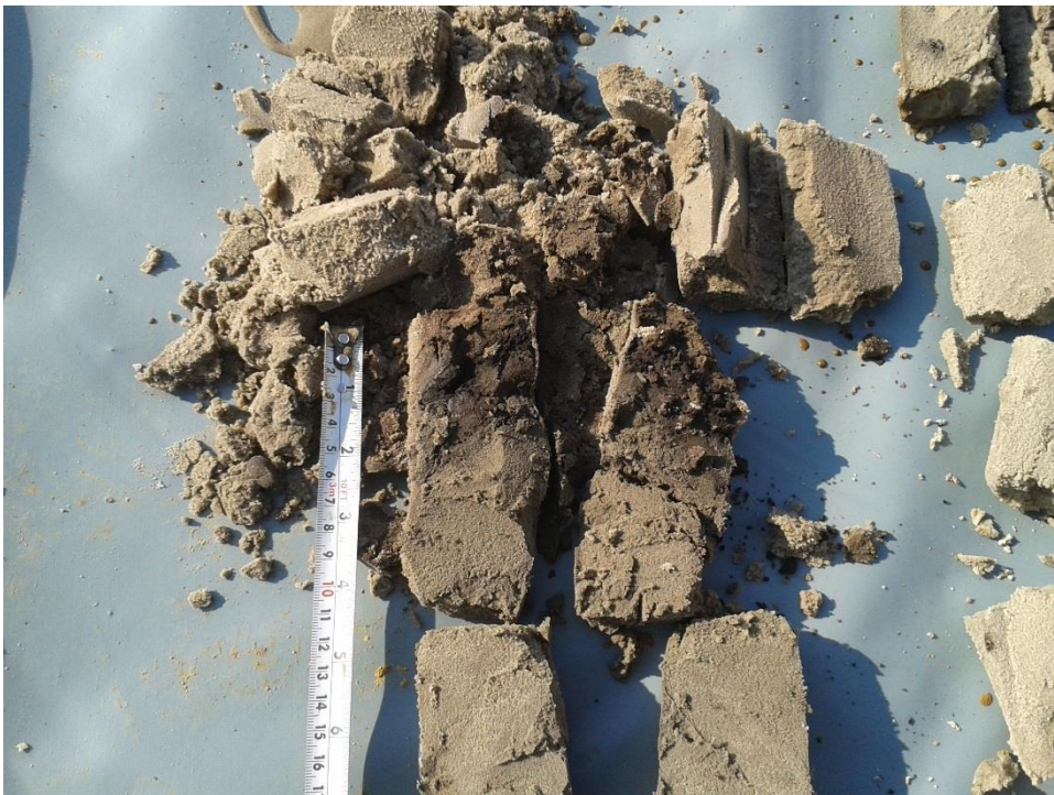
Foto 4: detail kleilens met veen van boring B3
