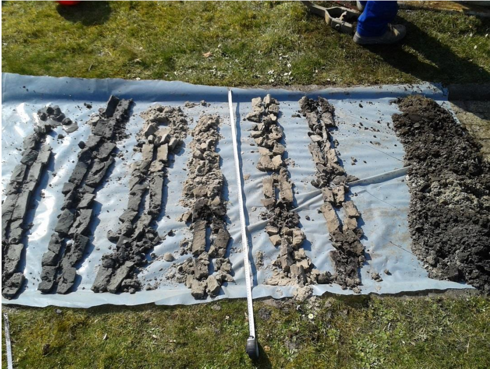
Foto 3: opgeboorde grond van boring B3 van rechts (0 m) naar links (8 m)
