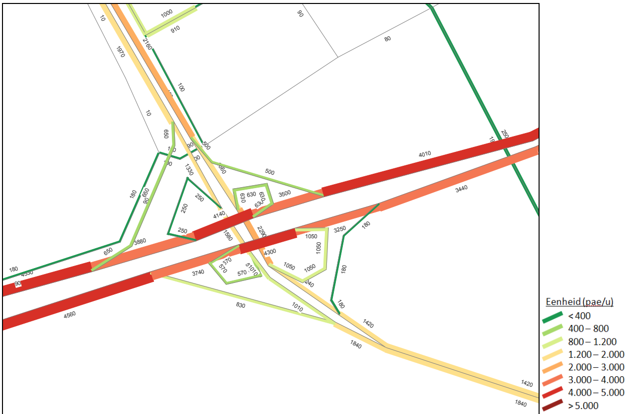
Figuur 3-8 Unimodale doorrekeningen provinciaal verkeersmodel Oost-Vlaanderen 2007 (v3.5) – gemiddeld avondspitsuur – detail E17 – N16
