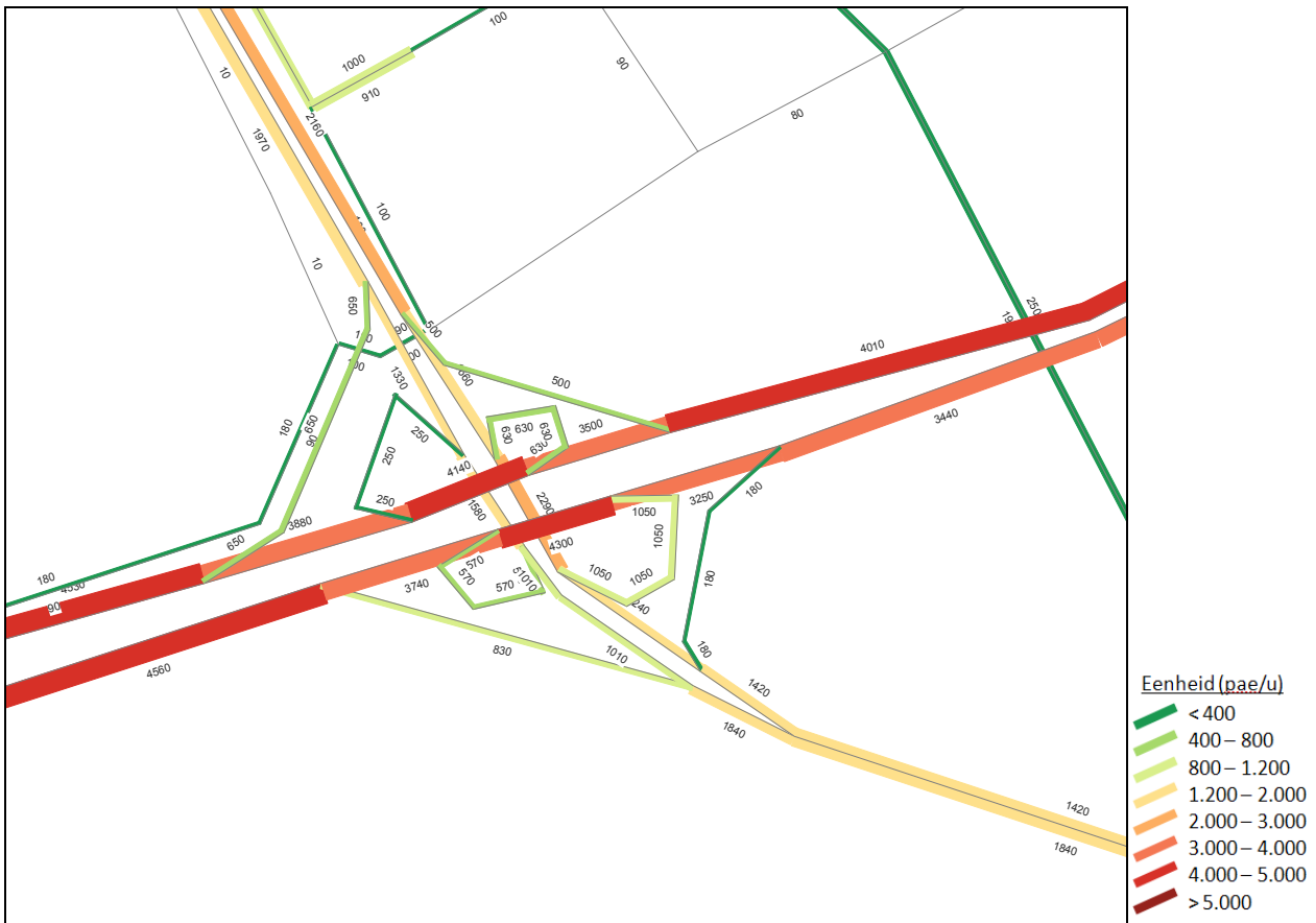
Figuur 6-12 Unimodale doorrekeningen provinciaal verkeersmodel Oost-Vlaanderen 2007 (v3.5) – gemiddeld avondspitsuur – detail E17 – N16
