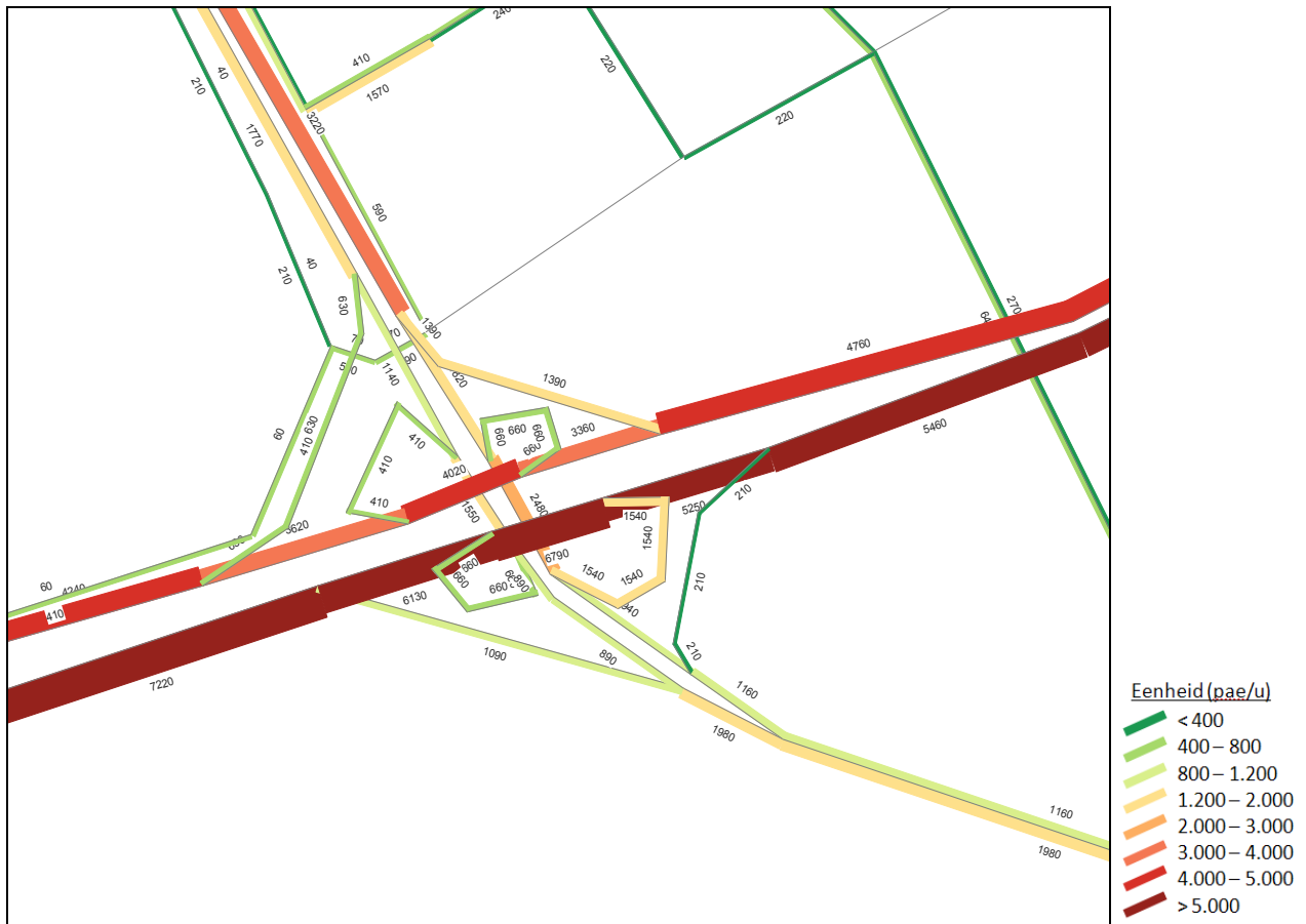
Figuur 6-15 Unimodale doorrekeningen provinciaal verkeersmodel Oost-Vlaanderen 2020 BAU zonder Oostelijke Tangent – gemiddeld ochtendspitsuur – detail E17 – N16
