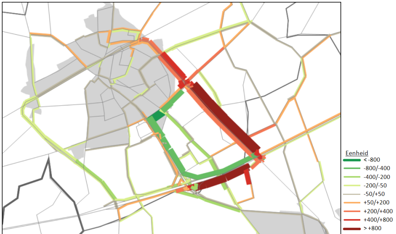
Figuur 6-21 Verschillenplot Unimodale doorrekeningen provinciaal verkeersmodel Oost-Vlaanderen – scenario 2 2020 vs Unimodale doorrekeningen provinciaal verkeersmodel Oost-Vlaanderen 2020 BAU zonder Oostelijke Tangent – gemiddeld ochtendspitsuur
