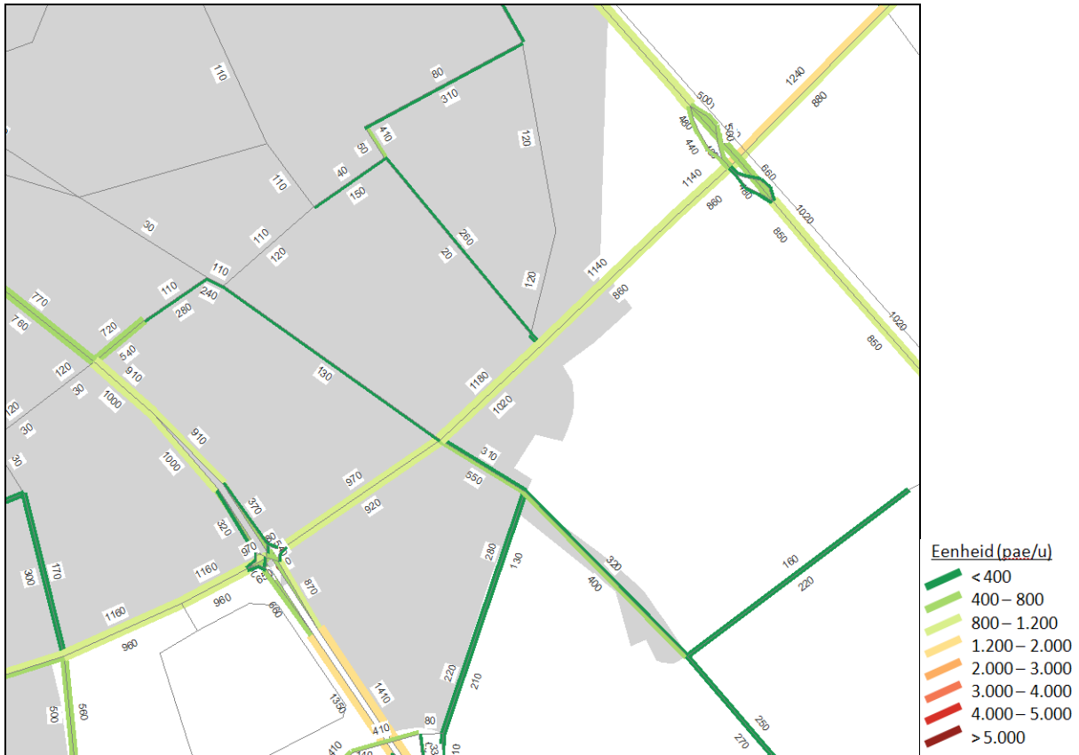
Figuur 6-27 Unimodale doorrekeningen provinciaal verkeersmodel Oost-Vlaanderen - scenario 2 2020 – gemiddeld avondspitsuur – detail N16 – N70 – R42
