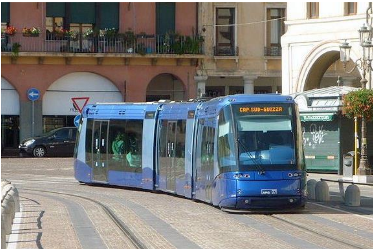
Figuur 2-4. referentiebeeld vrije bedding, en plaatselijk zonder bovenleiding (Padua)
